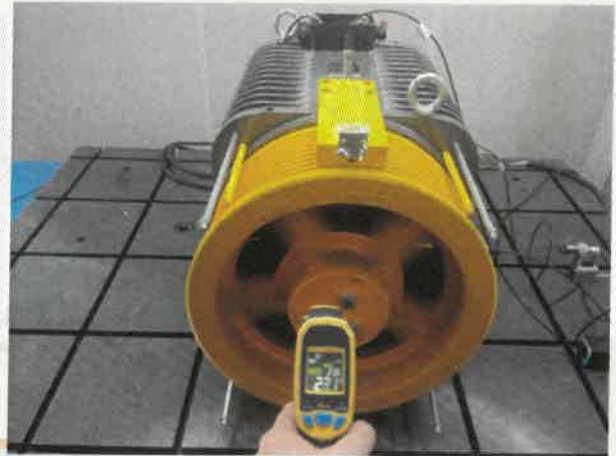
[사진 2] 무부하 운전 소음 및 온도 측정
