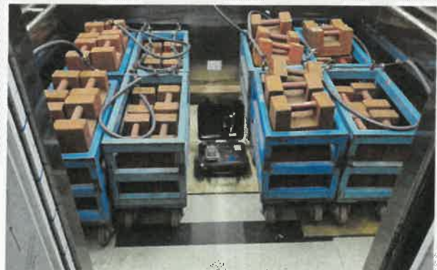
[사진 6] 동하중 시험 감속도 측정
