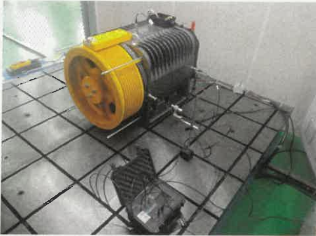
[사진 1] 무부하 운전 정격속도 및 진동 측정
