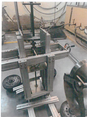
(1) 방수시험기 설치 사진
